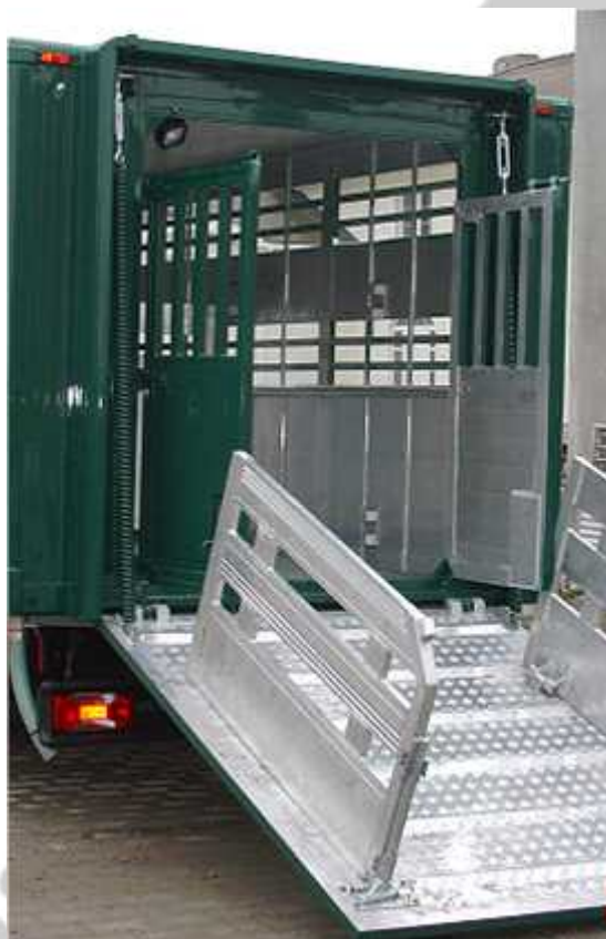
Rys. 4 – Rampa w stanie gotowym do załadunku
