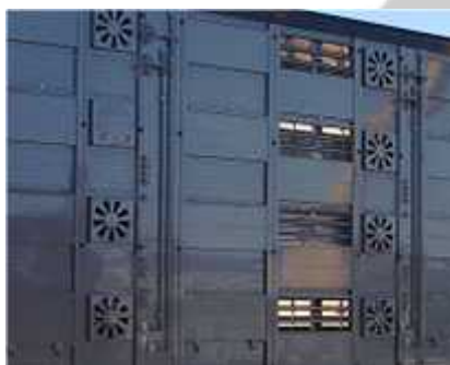
Rys. 8 – Żaluzje wentylacyjne sterowane ręcznie
