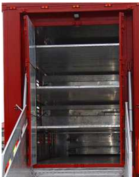
Rys. 2 – Widok pokładów od strony rampy załadowniczej
